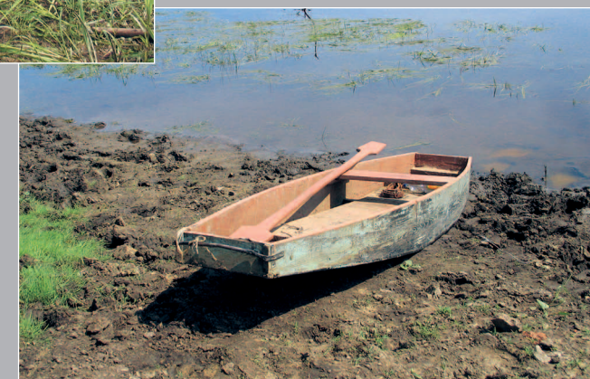
89 (9). Лодка-шитик — однонаббйница, на каждой стороне которой набито по одной доске — наббйнице. Село Бедёя Кежемского района Красноярского края. Фото 2005 г.
