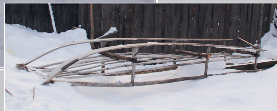
892. Самодельные нарты — узкие и длинные санки с деревянным настилом, употребляемые на Севере для езды на собаках и оленях. Село Кривляк Енисейского района Красноярского края. Фото 1983 г.
