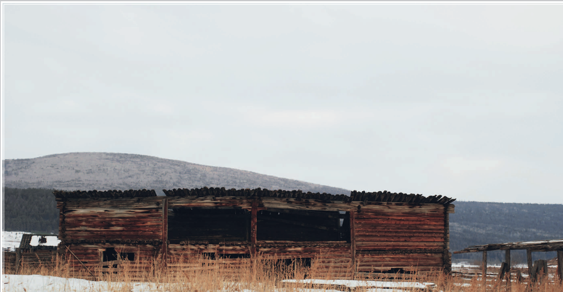
844. Четырёхкамерная повётъ под желобковой крышей — помещение, используемое для хранения сена, соломы (верхняя часть) и содержания домашнего скота (нижняя часть). Село Заплёскино Жигаловского района Иркутской области. Фото 1998 г.
