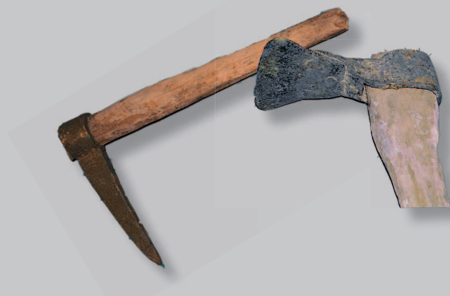
752. Кайла́ (землекопное орудие) и пазни́к (плотницкий инструмент для выемки пазов). Село Чингиль Калганского района Читинской области. Фото 1986 г.
