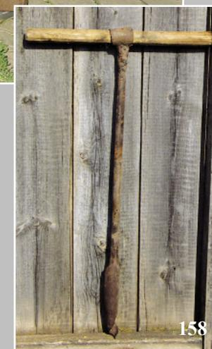
158. Напарье — инструмент, используемый при строительстве карбаса. Деревня Шёметово Качугского района Иркутской области. Фото 1980 г.
